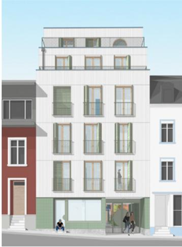
Die vorgehängte Fassade aus Holzbauelementen wird zur Strasse mit einer dünnen Wetterschicht aus Metall und zum Hof mit einer Holzschalung verkleidet.
